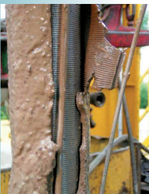
Enveloppe de boue polymère et de sédiments autour de la crépine dans l'intervalle de test
