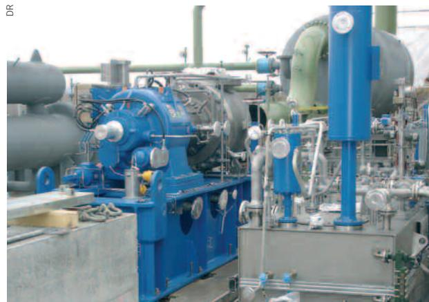
Turbine : Les calories transmises par le gaz actionnent mécaniquement la turbine qui entraîne le générateur.
