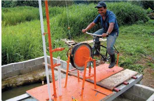
Une pompe à eau pour usage agricole conçue par Maya Pedal
