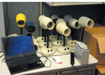
Le Personal Comfort System développé par des chercheurs de Berkeley utilise notamment de petits ventilateurs de bureau orientables de ce type.
